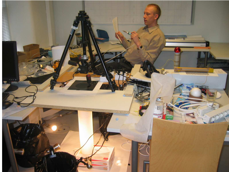
Kuva 2. Diffuusi valaistus luotiin spottilampuilla, lampunvarjostimella, jonka sisällä oli lisäksi voipaperia. Tärinä vaimennettiin sinitarralla.
