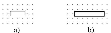
Kuva 63. Piirrosmerkkejä: a) vastus (SFS-EN 60617-4-01-01) ja b) siirtojohto (Valtonen 2004).
